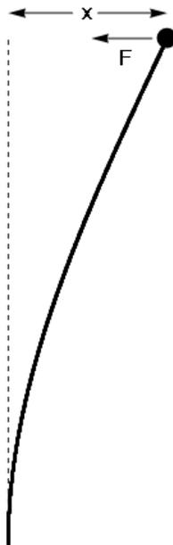
FIGURE 5 – Lame ressort (montre à quartz électronique).
