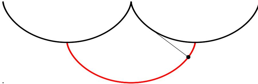
On peut forcer une bille à l'extrémité d'un fil souple à parcourir une cycloïde en utilisant des flancs cycloïdaux.
