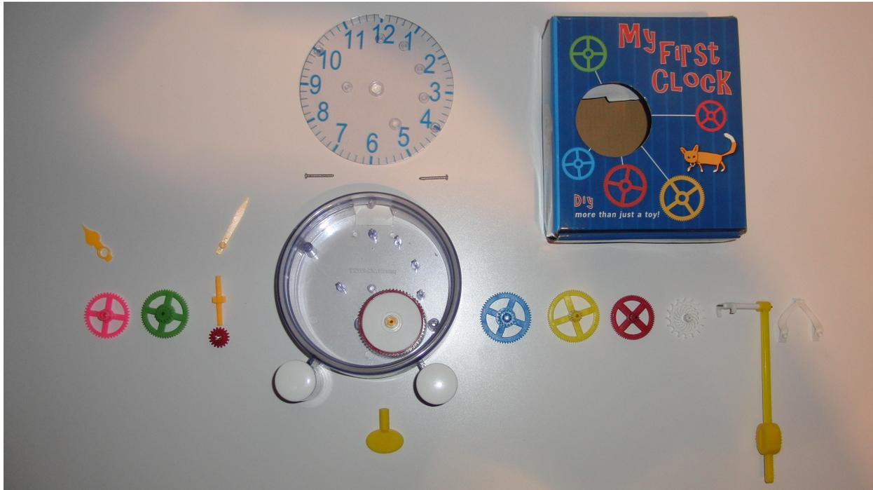
FIGURE 4 - Affichage  $\leftarrow$  Energie  $\Rightarrow$  Transmission  $\Rightarrow$  Echappement  $\Rightarrow$  Régulateur.
